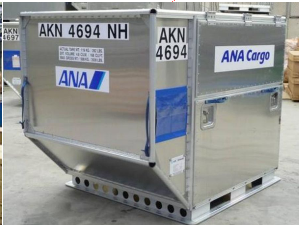
Unit load – ULD - contêiner aéreo
